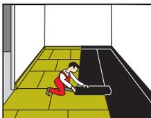
Se extiende una lámina de plástico en toda la superficie, para evitar filtraciones de hormigón.
