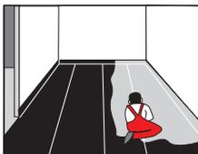
Aplicar una capa de compresión y antes de que fragüe poner los soportes sobre los que luego irán los tubos de la calefacción.
