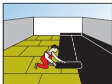
Sobre la lana de roca se extiende la lámina aislante, que se une por soldaduras.
