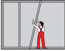
Fijar la estructura metálica. Entre montantes una distancia entre 400 mm o 600 mm.
