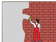
Se extiende una capa de mortero sobre el tabique de ladrillo, asegurando así la estanqueidad acústica.
