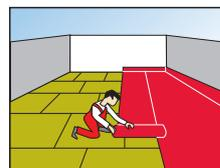
Extender una lámina impermeabilizante de alta calidad.
