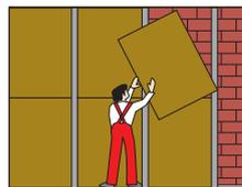
Colocar la estructura metálica de perfiles. Se ha de evitar el contacto con la fábrica de ladrillo para evitar posibles puentes acústicos.
