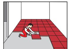
Se colocan el acabado, respetando una junta de dilatación de al menos 5 mm. respecto a muros y tabiques.
