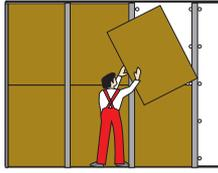
Se atornillan los paneles de lana de roca entre los montantes
