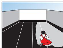
Colocación de una lámina geotextil, y sobre ésta una capa de mortero armado de al menos 4 cm. de espesor.
