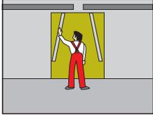
Colocar los paneles en la pared e instalar la estructura metálica donde irá la campana.
