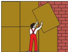
Se fijan los paneles sobre el enfoscado mediante presión manual. No dejar pasar más de 20 minutos entre la aplicación del mortero y la colocación de los paneles.
