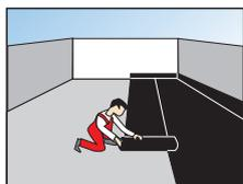
Se puede colocar como barrera de vapor una lámina de polietileno mediante una imprimación.
