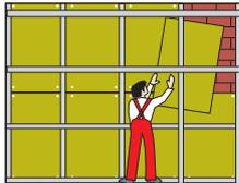
Colocar los paneles de lana de roca con fijación mecánica, y colocar la estructura metálica vertical sobre los anclajes.
