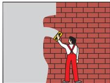
Aplicar el mortero sobre el tabique, de al menos un espesor de 5mm.
