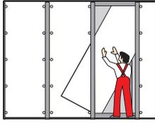
Se atornilla una placa de yeso a una de las caras de la estructura laminada. Y otra placa de yeso se atornilla a la primera.
