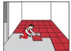
Colocar el acabado siempre respetando las juntas de dilatación de al menos 5 mm respecto a muros y tabiques.
