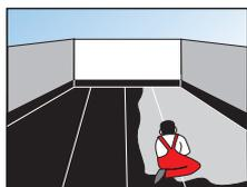
Encima de la barrera de vapor se coloca una fijación adhesiva y para unir las placas.
