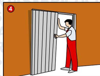
4 Colocar el armazón, nivelar y fijar a la pared con unos puntos de cemento y yeso.
