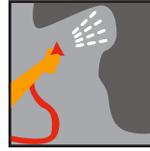
Cuando el material empieza a endurecer, aplicar una segunda capa de 3 mm.
