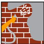
Extender el producto con llana o máquina de proyectar, hasta conseguir un espesor mínimo de 10-15 mm.
