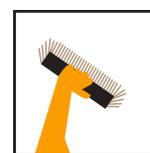
**Acabado raspado:** una vez iniciado el endurecimiento, realizar el acabado con un raspador, manteniendo un espesor mínimo de 10 mm en cualquier punto.
