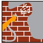
**Para el acabado liso:** Aplicar una primera capa a llana o a máquina para regularizar la absorción y planeidad del soporte.
