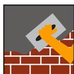
Extender el producto con llana y reglearlo para regular el espesor, hasta conseguir un mínimo de 10 mm en cualquier punto.
