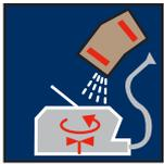
Amasar con 8-9 litros de agua limpia por saco, manual o mecánicamente, hasta su total homogeneización.
