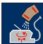
Amasar con 10- 11 litros de agua limpia por saco, manual o mecánicamente hasta su total homogeneización.
