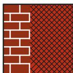
Armar con malla para mortero en las uniones entre diferente soportes.
