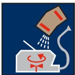
Amasar con 6 litros de agua limpia por saco, manual o mecánicamente, hasta su total homogeneización.
