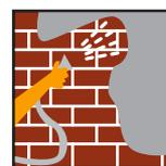
Extender el producto con la máquina de proyectar o con una llana, hasta conseguir un espesor mínimo de 10- 15 mm.
