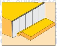
CUBIERTAS RAMPAS Y PASARELAS. Posición inclinada, tanto en pendiente como en perpendicular. En pasarelas es suficiente recibir las placas en sus apoyos, macizar sus juntas, colocar las barandillas y realizar los acabados convenientes, para tener la pasarela en condiciones de servicio. La utilidad se extiende, también, a la ejecución de la rampa de acceso a la pasarela.
