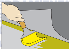
Para adherir la lámina al suelo y a la pared, se utiliza otro adhesivo especial.
