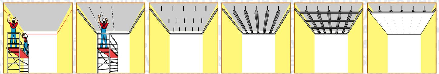
Se toman los puntos de nivel y se trazan las líneas de marcado a lo largo de todo el perímetro. Se traza así la posición de los perfiles perimetrales y de los PH45 y T 47.
