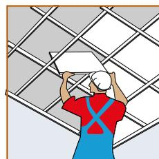
Pasar las placas o paneles por encima de la perfilería y le colocan dejándolos sobre los perfiles.
