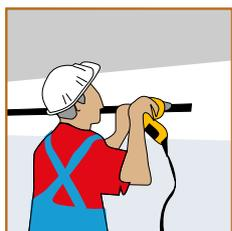
Fijar el perfil medianero clavos o tornillos dependiendo del soporte. La separación máxima entre fijaciones será de 35 cm.
